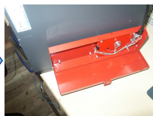
付属のネジでコインユニットをパソコンの蓋に取り付けます。
